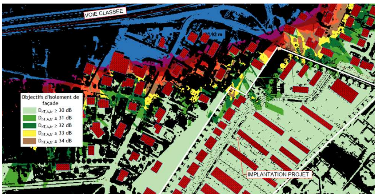
Cartographie du bruit de la voie classée à proximité du projet, au R+1
